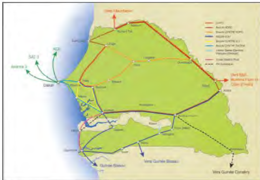
Figure 2.2.2.3.b : Synoptique des réseaux de transmission de SONATEL
